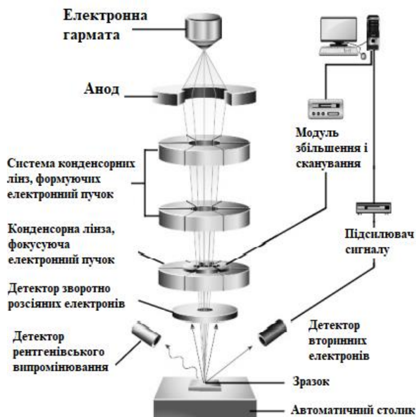
Рис.1.2.1.1. Принципова схема растрового електронного мікроскопа
