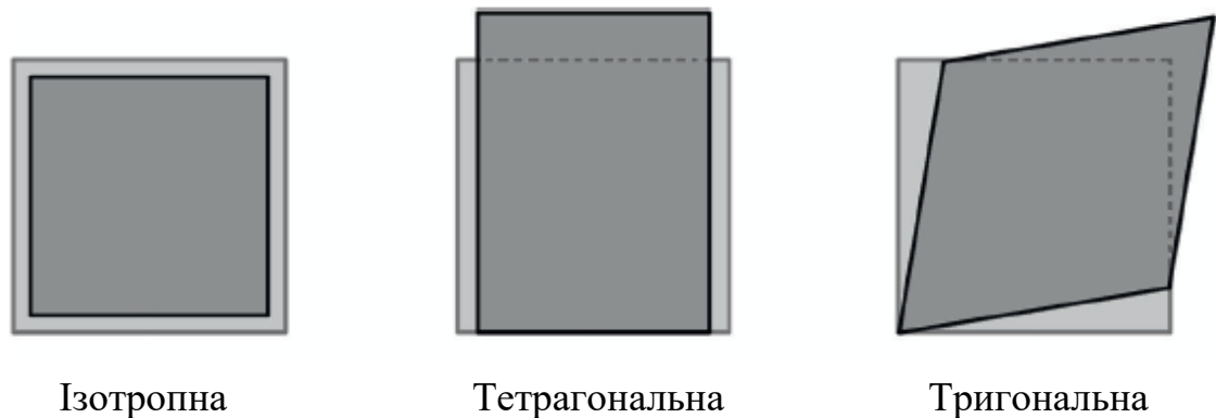
Рис. 6. Структурні деформації, які використовуються для визначення пружних констант C_{11} , C_{12} і C_{44} кубічного кристала. Схематично зображено двовимірні деформації, а їх величина перебільшена для наочності.
