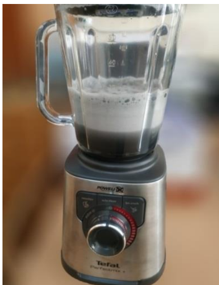
Рис.2.1. Суспензія графену у водному розчині ПВП при використанні кухонного блендера
