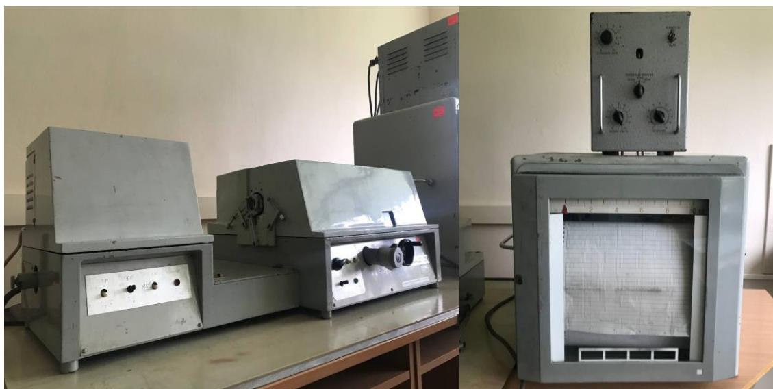
Рис. 2.12. Спектрометр інфрачервоний ИКС-21.
