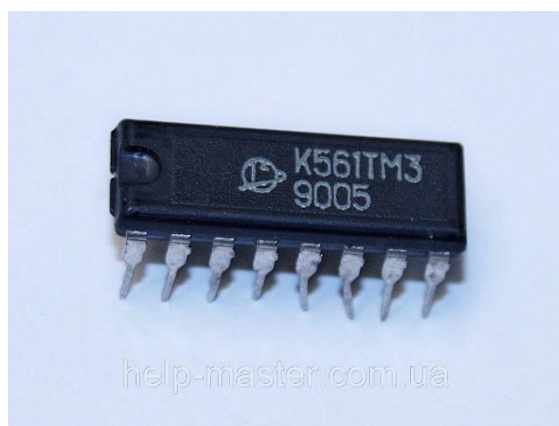
Рис. 2.6. Вигляд та графічне зображення мікросхеми К561ТМ3.
