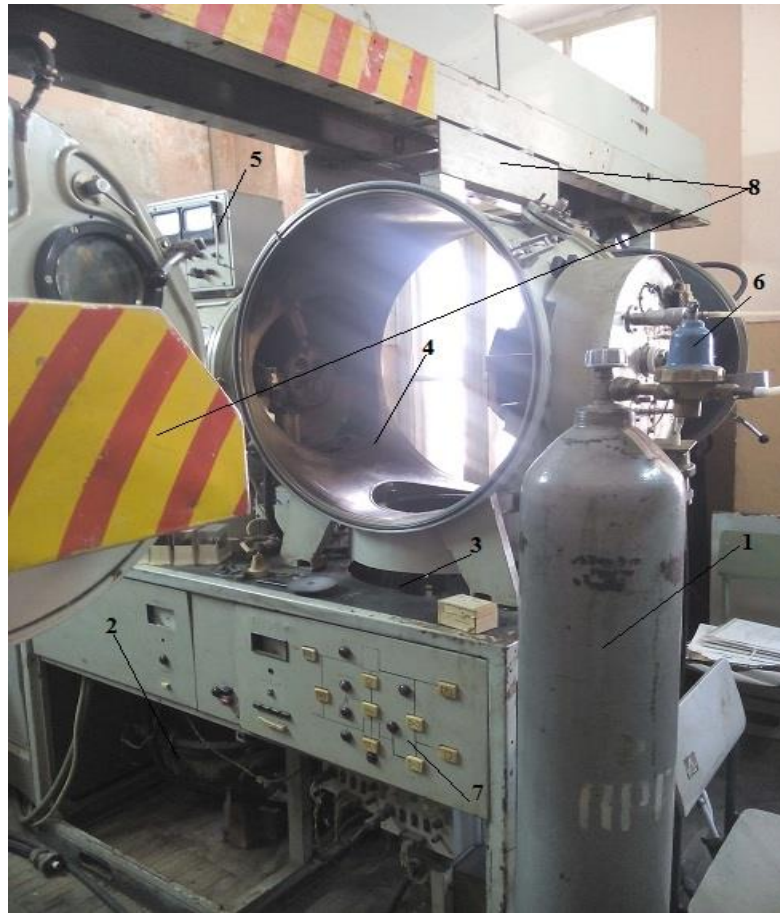
Рис. 2.2. Основні вузли установки УВР – 75 для ВЧ-катодного розпилювання: 1-балон з аргоном, 2-форвакуумний насос, 3-дифузійний насос, 4-робочий об'єм, 5-вакууметр, 6-вентиль для дозованого напуску аргону, 7- пульт керування відкачкою, 8 –механізм приєднання герметизуючих кришок до робочого об'єму.
