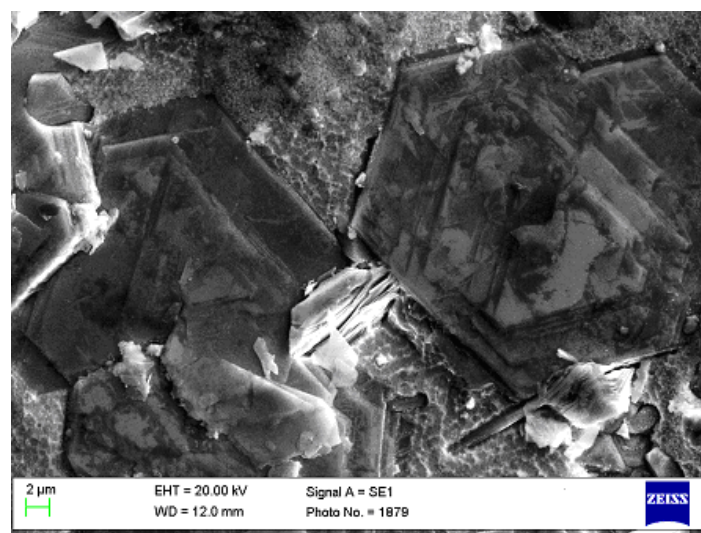
Рис. 2.12. Структура епітаксійного шару \text{In}_4\text{Se}_3 до ЛО (а); після ЛО з інтенсивністю I_0=20 \text{ кВт/см}^2 (б) ; після ЛО з I_0=22 \text{ кВт/см}^2 (в).
