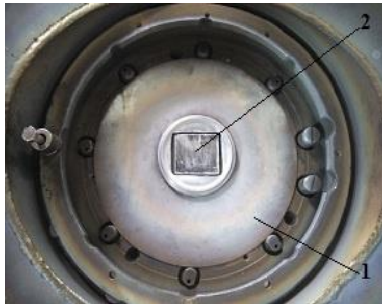
Рис. 2.3. Вузол катода-мішені: 1- катод охолоджуваний водою, 2- мішень – пластина, виготовлена з монокристалу CdSb.
