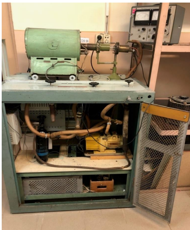
Рис.2.2. Зовнішній вигляд установки для проведення процесу РФЕ: зверху – пічка та робоча камера; знизу – насос, балон з Ag, регулятор температури ВРТ-3.
