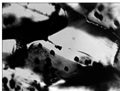
Рис. 2.10. Дислокаційні ямки травлення на поверхні епітаксійного шару CdSb.
