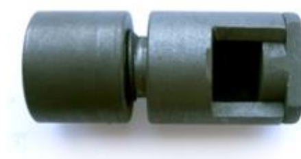
Рис. 2.3. Контейнер для проведення процесу рідиннофазної епітаксії.
