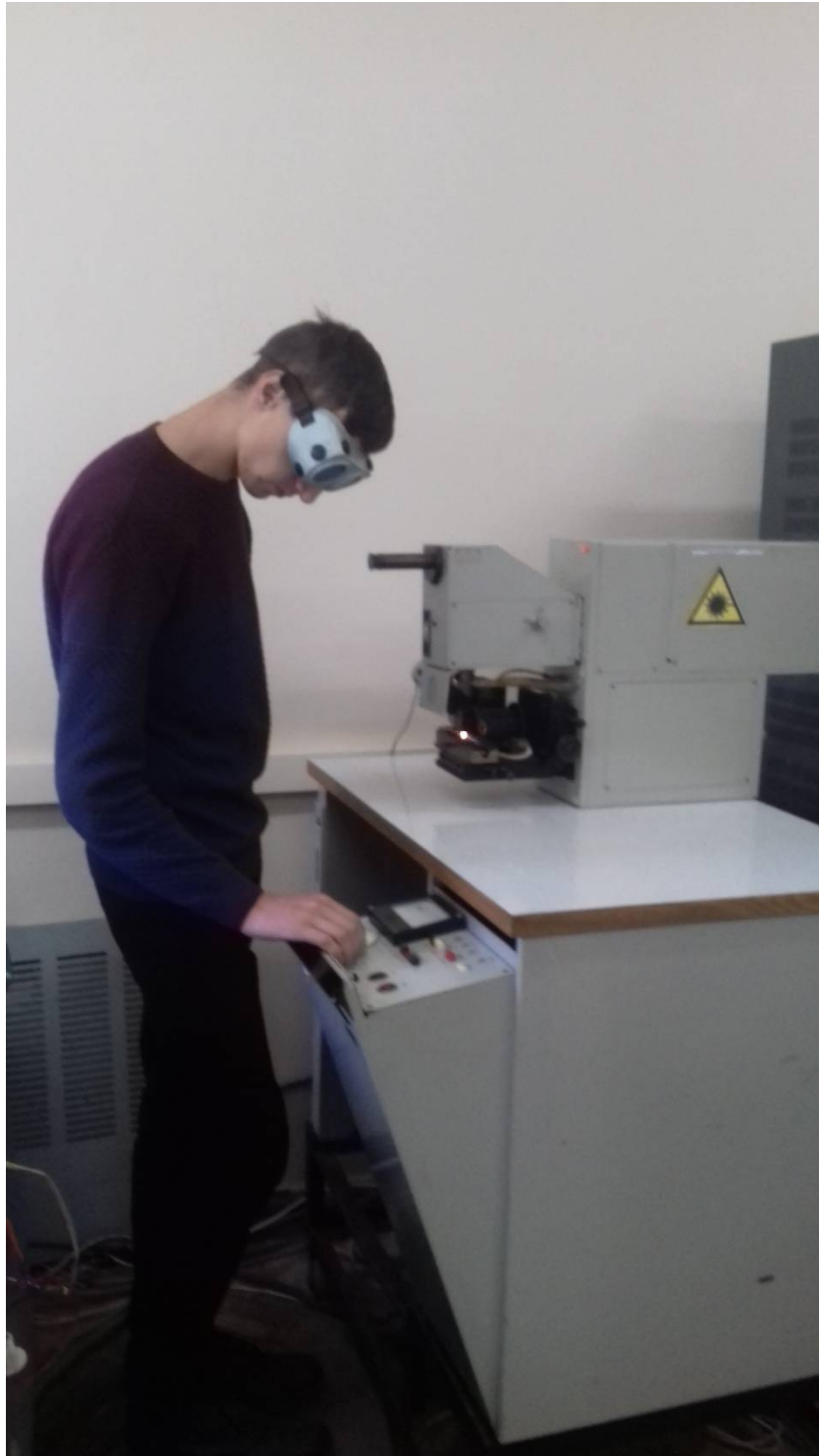
Проведення процесу скрайбування на лазерній установці "Квант-12".
